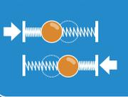
自動振動吸收器機件啟動時，轉換曲軸箱和汽缸之間的空氣壓力，可有效控制平衡器到相反位置。
