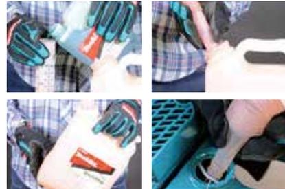
使用前需要混合汽油及機油，再倒入工具才可起動。
