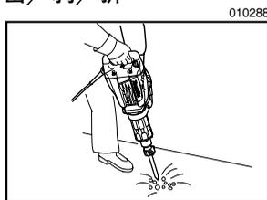
操作期间，请务必同时抓牢侧把手（辅助手柄）和开关手柄，紧紧握住工具。开动工具并轻轻按压，这样工具不会失控往四周弹跳。用力按压工具并不会提高效率。
