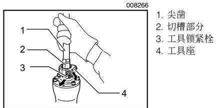
将尖凿杆上的切槽朝向工具锁紧栓，将尖凿插到工具座中，尽量插到底，然后拉出工具锁紧栓并旋转 180 度，固定住尖凿。安装之后，请务必试着拉动尖凿，确认尖凿已经固定到位。
