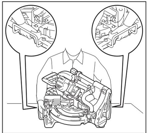
**警告：**抬升刀架的止動銷僅供搬運與存放用途，並非用於任何切割操作。將止動銷用於切割操作可能會造成圓鋸機鋸片意外移動，而導致反彈和嚴重的人員傷害。
