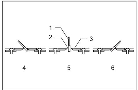
► 1. 鋸片 2. 鋸齒 3. 鋸痕板 4. 左斜切割
