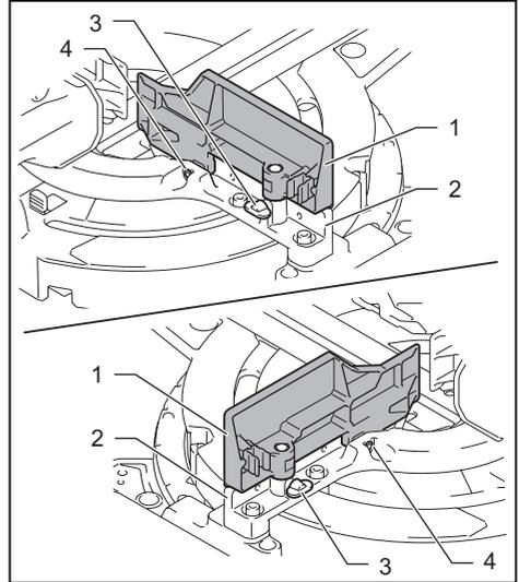
▶ 1. 上導板 2. 下導板 3. 夾緊螺絲 4. 調整螺絲
