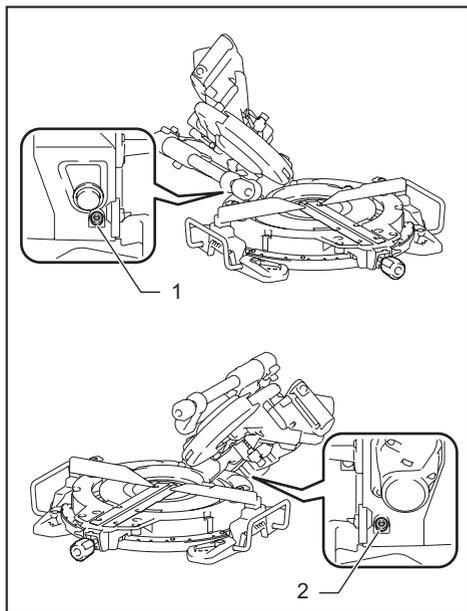
► 1. 左側 45° 調整螺栓 2. 右側 45° 調整螺栓
