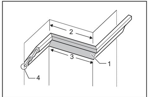
► 1. 工件 2. 牆體寬度 3. 工件寬度 4. 牆體接觸邊
