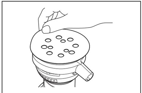
若要安装砂轮片，请先清除垫片上所有的污垢或异物。然后撕下砂轮片上的保护纸并将砂轮片安装至垫片。请将砂轮片上的孔和垫片上的孔仔细对齐。
