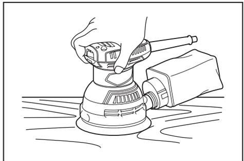
请牢握本工具。启动工具后应等待其达到全速运转时再进行操作。将工具轻轻放置于工件表面上。垫片与工件保持平齐，对工具轻微施力。
