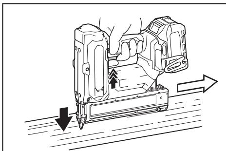
如果釘針的頭部突出工件表面，請將釘槍頭部確實抵住工件再打釘。
