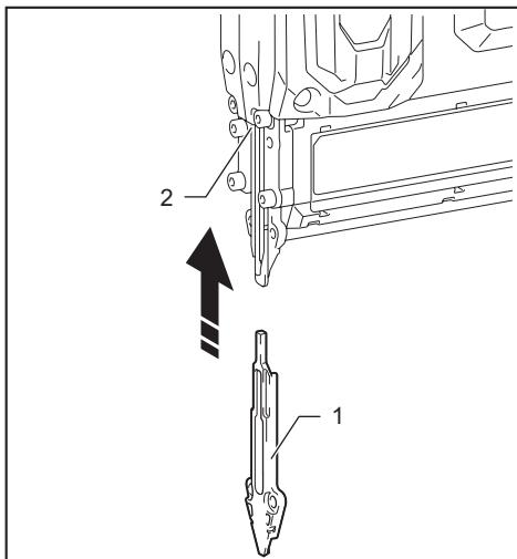
► 1. 選購的打釘導板 2. 導板插槽
