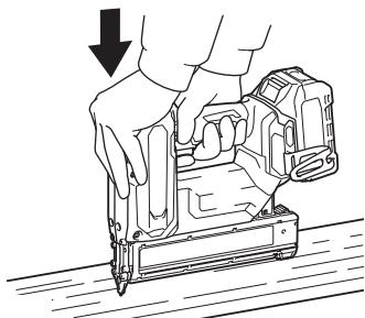
**注：**若即使固定釘槍頭部，釘針頭部仍突出工件表面，則該材料可能不適用於打釘。若仍繼續在此類材料上進行打釘，可能導致釘槍驅動裝置受損及／或釘槍卡釘。
