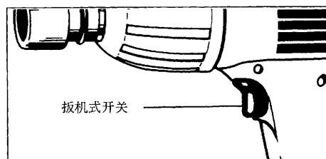
\* 注意：要插电以前，须先检查工具的开关操作是否圆滑，扣上扳机再放松，扳机开关是否能够弹回原位(关闭)。
