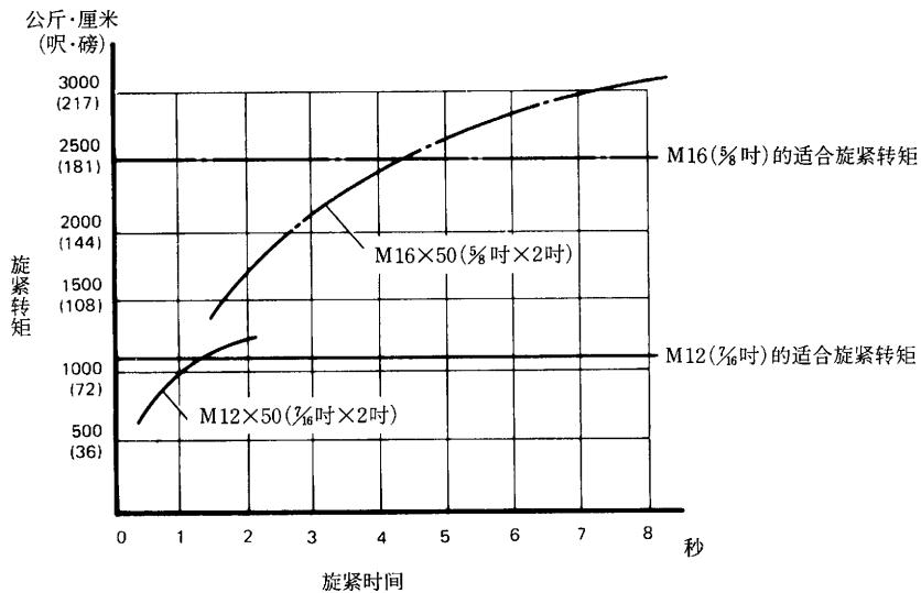
牢固地握住主机，并且把管状套筒套在螺栓或螺母上，使主机运转并按适当的拧紧时间把螺栓或螺母拧紧。
