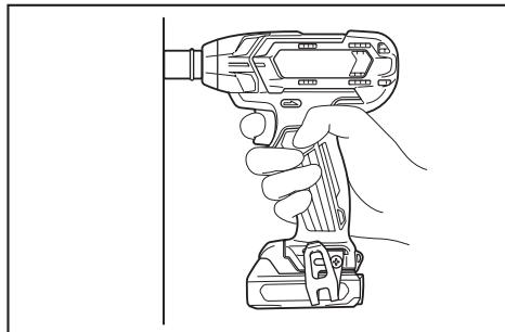
牢牢握住工具并将冲击套筒置于螺栓或螺母上。开启机器并以适当的紧固时间开始紧固。
