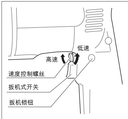
\* 注意：要插电以前，须先检查工具的开关操作是否圆滑，扣上扳机再放松，扳机开关是否能够弹回原位(关闭)。
