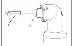
• 1. Insert bit 2. Spindle
