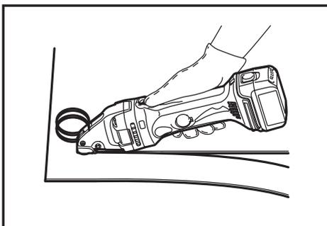
开启工具，将侧刀片的前端放在工件上。现在，只需将工具向前移动，保持侧刀片与工件表面平齐。
