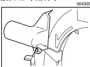
将接头安装到锯片基座的木片斜槽中，并用螺丝加以紧固。
