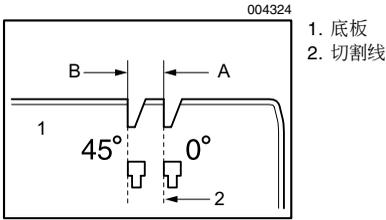
想要进行直线切割时，请将底板前方的 A 位置与加工件上的切割线对齐。想要进行 45° 斜面切割时，则请将 B 位置与其对齐。
