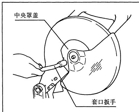
卸锯片时，首先要松开处于最低位置的手柄。按动轴的锁定装置，使锯片不能旋转，再使用套口扳手去松开六角螺栓。然后取下六角螺栓、外法兰盘以及锯片。
