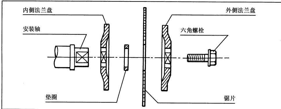
安装法兰盘和六角螺栓，然后按着锁轴，用套口扳手按逆时针方向完全拧紧六角螺栓。然后按顺时针方向调整六角螺栓，以扣紧中心盖。
