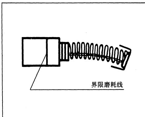
用螺丝起子取下碳刷夹盖子。取出磨损的碳刷，插进新的碳刷，然后拧紧碳刷夹盖子。
