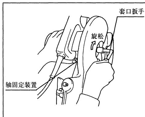
将锯片安装在中轴上，确认锯片表面上的箭头方向与锯片盖上的箭头一致。
