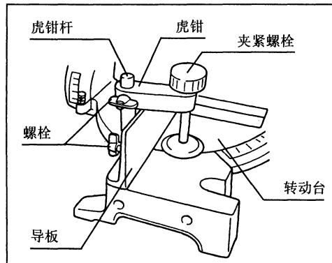
**注意：切割较长的工件时，要使用和转动台顶部平面一样高的支撑物进行支撑。**
