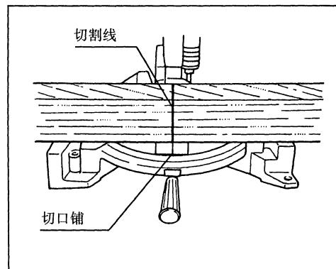
当使用本机进行切割时，同时会从工件上切割下相当于锯片厚度的一部分工件。因此，切割线应置于锯口板上槽口的左侧或右侧。打开机器开关后要等锯片达到全速时才可轻轻降下锯片进行切割。当锯片接触到工件时，逐渐地下压把手进行切割。切割结束后，关闭机器开关并等到锯片完全停止转动后，才可将锯片放归至其最高位置。否则切割下的断片将与锯片套接触而向四周飞溅从而造成危险。
