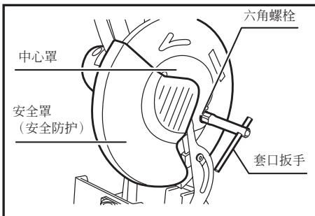
按下锁键使切割轮不能旋转，用套口扳手逆时针方向旋松六角螺栓，然后卸下六角螺栓、外法兰盘和锯片。
