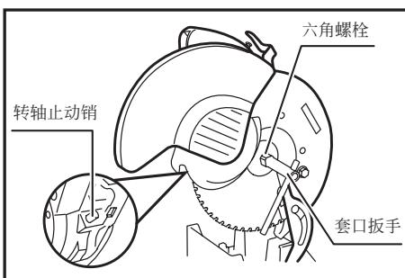
安装锯片时，按顺序在转轴上安装内法兰盘、锯片、外法兰盘和六角螺栓。顺时针旋转紧固六角螺栓同时按压转轴止动销。将安全罩（安全防护）和中心罩返回原位。然后顺时针紧固六角螺栓以紧固中心罩。降低手柄以确保安全罩正确移动。
