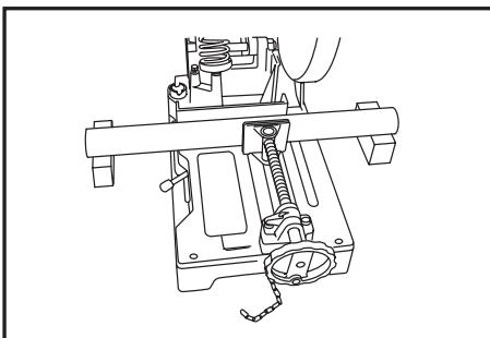
当切割角型或管道型材料时，如图 10-1 所示紧固角型材料，如图 10-2 所示紧固管道型材料。
