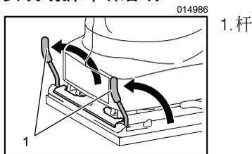
将杆从锁定端升起以打开研磨纸夹钳。将研磨纸一端插入夹钳的夹紧部分。
