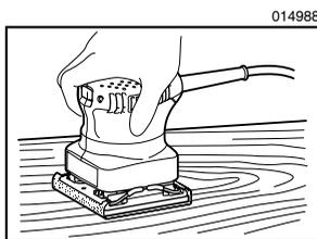
请牢握本工具。启动工具后应等待其达到全速运转时再进行操作。将工具轻轻放置于工件表面上。垫片与工件保持平齐，对工具轻微施力。
