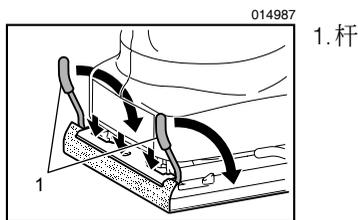
一旦研磨纸安装到位，请将杆放回原位。
