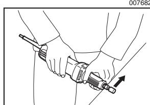
开启工具电源，勿使尖头磨轮与工件有任何接触，然后等待直至尖头磨轮达到全速。接着轻轻地将尖头磨轮抵到工件上。慢慢地向左侧移动工具使之顺利收尾。
