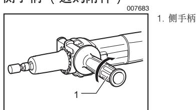
使用侧手柄时，请先取下橡胶保护套，将手柄尽可能深地插入工具的套筒并旋转至所需的角度。然后顺时针旋转手柄将其紧固。
