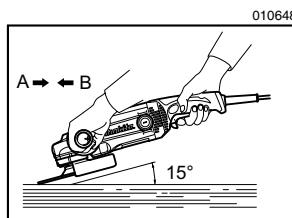
请务必用一只手抓住后手柄、另一只手抓住侧手柄牢固握持工具。打开工具开关,然后使用砂轮或砂轮片加工工件。
