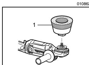
拔下工具电源并将其倒置以便操作主轴。拆下主轴上的任何附件。将杯形钢丝刷安装至主轴并用提供的板手加以紧固。使用钢丝刷时,避免施加过度的压力,这会导致钢丝弯折并造成过早破裂。
